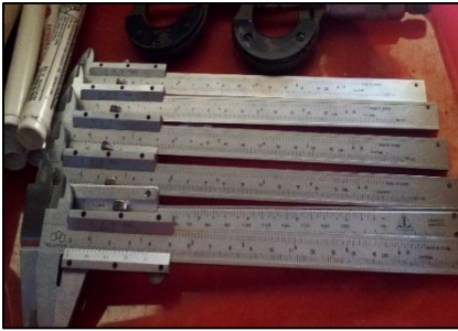
Gambar 3.33 Jangka sorong dalam kondisi baik
