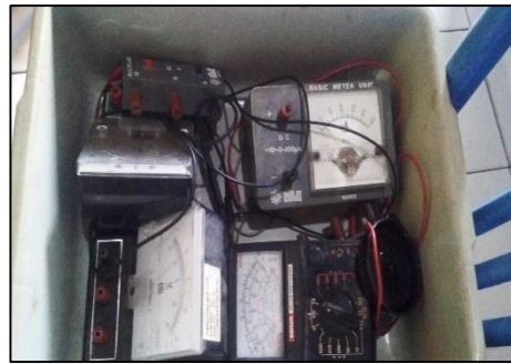
Gambar 3.30 Voltmeter dan amperemeter dalam kondisi rusak
