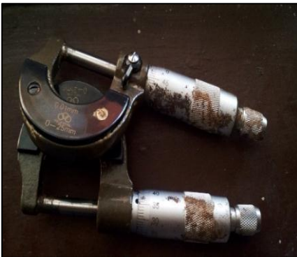
Gambar 3.27 Micrometer sekrup berkarat
