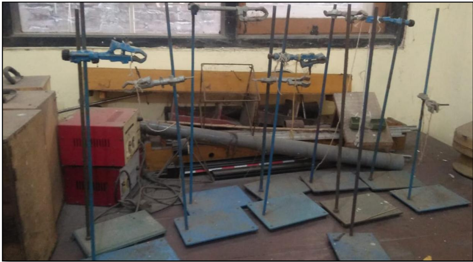
Gambar 3.87c. Alat penyangga yang sudah berkarat
